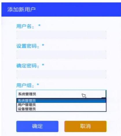
用户组：选择相应的用户组即可，系统管理员拥有管理的全部权限；用户管理员只能使用用户管理、网络设置、恢复出厂设置、日志、设备重启、时间设置、设备升级功能；设备管理员只能使用网络设置、设备重启、时间设置、设备升级功能。
