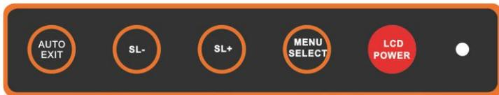
显示器调整功能主要依靠 OSD 控制键对显示功能进行调整，具体 OSD 控制键功能
